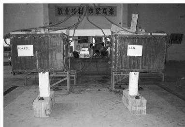
图 3 桥墩试件安装于台面后照片
