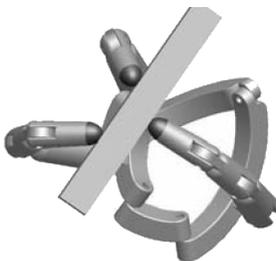
图11 3个手指两侧分布抓持长条状物体的姿态
