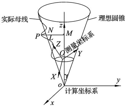
图 2 自适应圆锥模型
