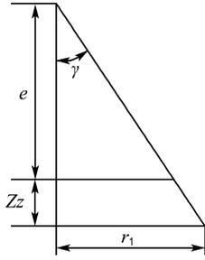
图 6 Z 轴平移量模型
