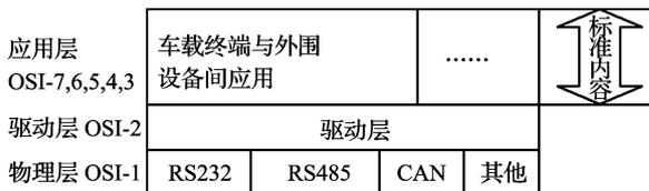
图 4 车载信息终端与外围设备间数据通信协议分层模型
