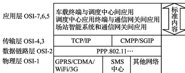
图2 快速公交智能系统通信协议分层模型
