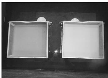
图 7 砂样的毛细渗透过程
