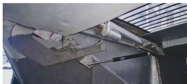
图 6 样车变形机构布置实拍图
