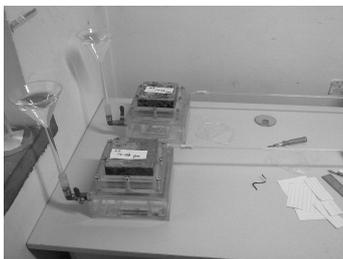
图 3 累积吸水试验装置示意图
