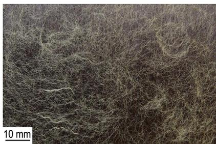
图 1 芳纶短纤维薄膜(面密度  $3 \text{ g/m}^2$ )
