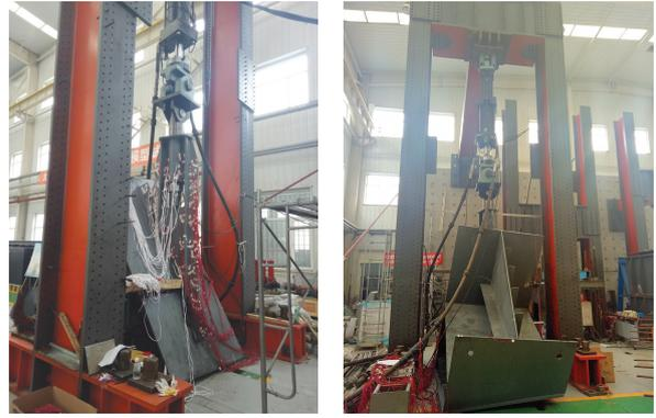
图10 锚拉板疲劳试验
