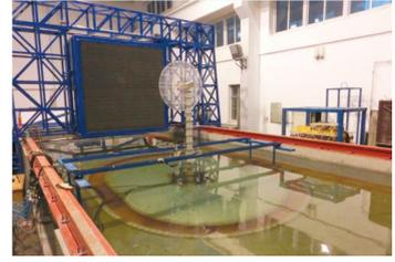
图 2 地震、风、波流作用下海上风机模型试验
