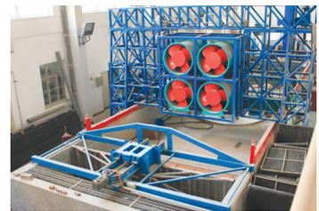
图 1 波流、地震、风联合模拟系统
